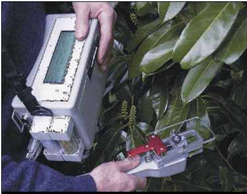
Figura 7. Spettrometro infrarosso portatile per l'analisi quantitativa di gas sulla superficie fogliare
