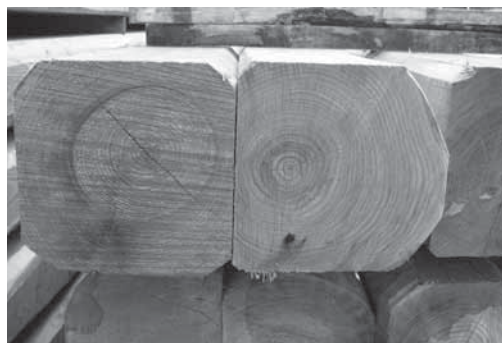
Fig. 2. Travi di castagno "Usò Fiume". Gli assortimenti vengono squadrati e successivamente piallati a mano con smusso fino alla punta, mantenendo una sezione costante. A sinistra, lavorazione effettuata con pialla a mano di travi in castagno "Usò Fiume" e, a destra, particolare di alcune sezioni con smusso
