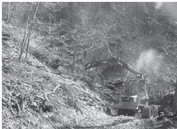
Fig. 3. Campo Ligure (GE), 2007: Trasporter forestale impegnato nell'esbosco e trasporto degli assortimenti dell'utilizzazione del ceduo castanile
