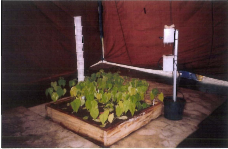
Photo 1. Micro-parcelle de haricots (70 x 70 cm) et capteurs de spores mis en place sous le simulateur de pluie.
