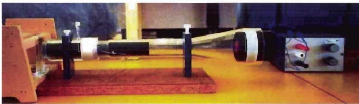
Photo 1. Tunnel à vent utilisé pour étudier les effets de différents facteurs sur la libération des spores de P. griseola par simulations de vent.
