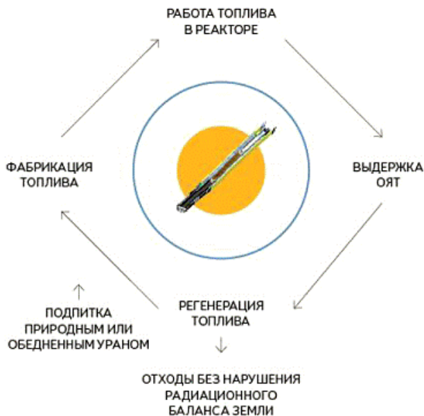
Рис. 1.3. Схема замкнутого ядерного топливного цикла реактора БРЕСТ-ОД-300 [http://rareearth.ru/ru/pub/20160420/02478.html]
