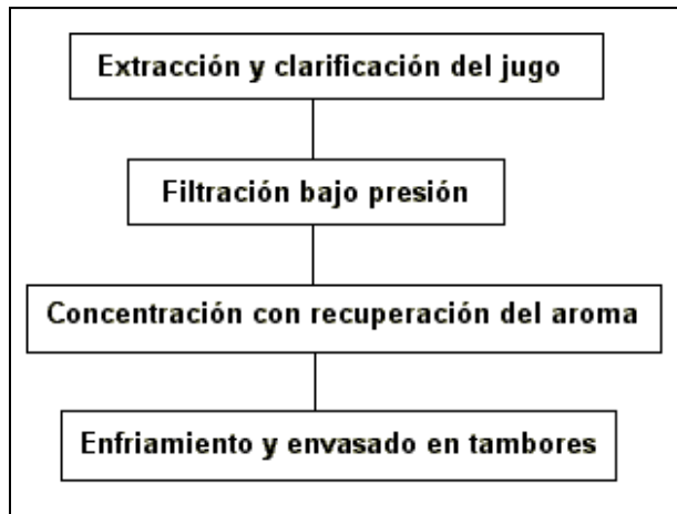
Figura 13. Diagrama de flujo del proceso de elaboración de jugos concentrados de berries (INTEC, 1986; Valdebenito et al. , 2006).
