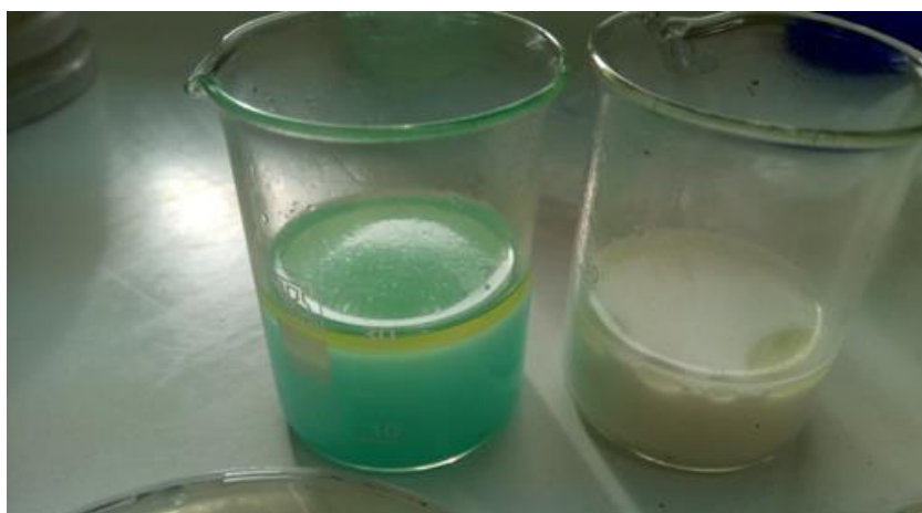
Εικόνα 14. Διαχωρισμός συστατικών των Νάνο-γαλακτωμάτων, ως αποτέλεσμα της παρουσίας περίσσειας επιφανειοδραστικής ουσίας. Αριστερά: Νάνο-γαλάκτωμα αιθέριων ελαίων με προσθήκη χαλκού. Δεξιά: Νάνο-γαλάκτωμα αιθέριων ελαίων. (Πηγή: Εργαστήριο Φυτοπαθολογίας, Π.Θ)
