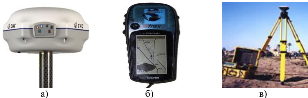
1-расм. GPS приёмниклари, а - штативга ўрнатиладиган GPS, б – қўлда кўтариб юришга мўлжалланган GPS, в – штативга ўрнатилган GPS.
