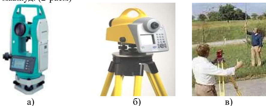
2-расм. Электрон геодезик асбоблар. а – электрон теодолит, б – электрон нивелир, в - электрон асбобларда план олиш ишлари.
