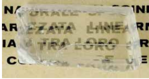
Fig. 13: Fenomeno della doppia rifrazione della calcite (MR 3674) (1 campione ~cm 5). Fig. 13: The light double refraction of Calcite (MR 3674) (1 campione ~cm 5).
