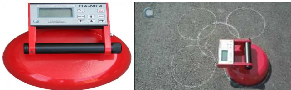
Рис. 1. Обзор ПА-МГ4 и методики определения плотности покрытия
