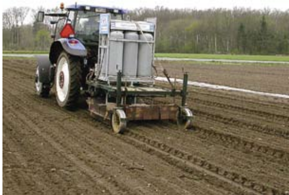
Figur 1.29 Til store flammeaggregat er det en fordel med store gassflaskepakker som gir lavere pris og enklere håndtering. Bildet viser et flammeaggregat for JTI for bredflamming med gassflaskepakke VP260 for væskeuttak. Foto: Johan Ascard.
