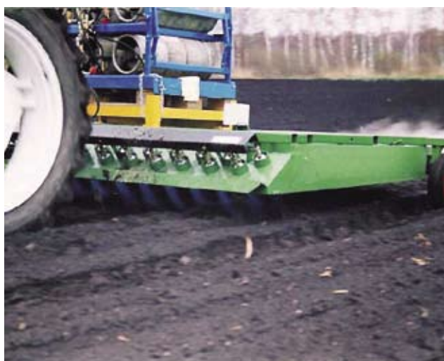
Figur 1.32 Envo-Dan flammeaggregat for bredflamming på store areal. Redskapet har propan i væskefase fra liggende propanflasker og forbrenning i væskefasebrennere. Foto: Bill Alsted.
