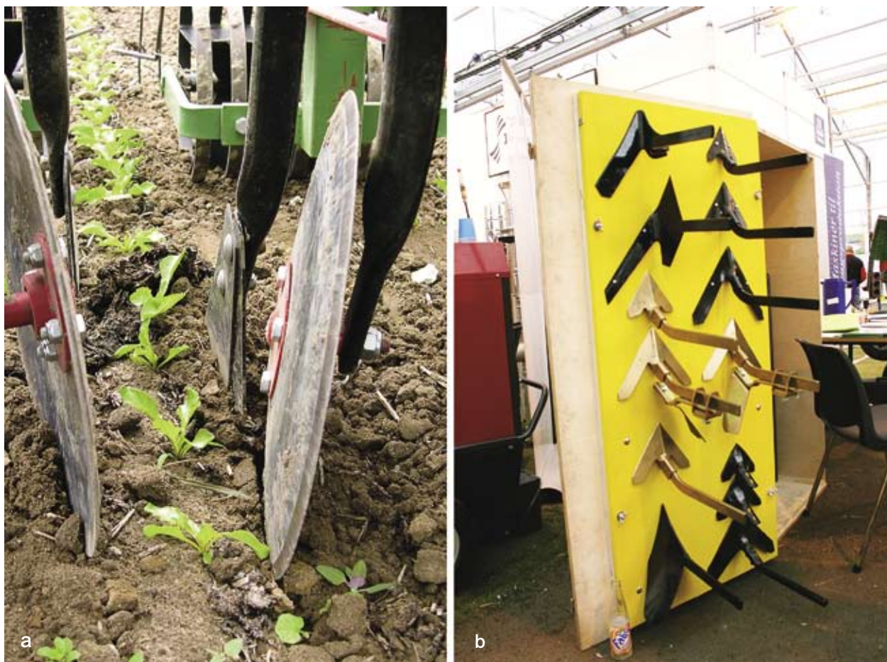
Figur 1.38 a) Med rulleskjær på radrenseren kan man komme nær raden. b) Det finnes mange typer gåsefot- og L- skjær. Foto: a) Johan Ascard b) Kari Bysveen.
