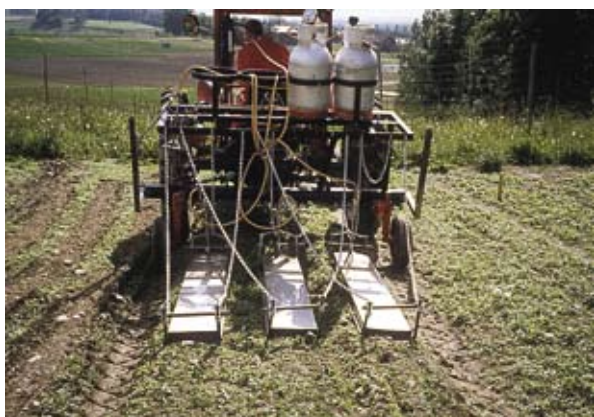
Figur 1.34 Stripeflamming sparer mye propan, men fører til en mer komplisert redskapskonstruksjon. Foto: Ukjent.
