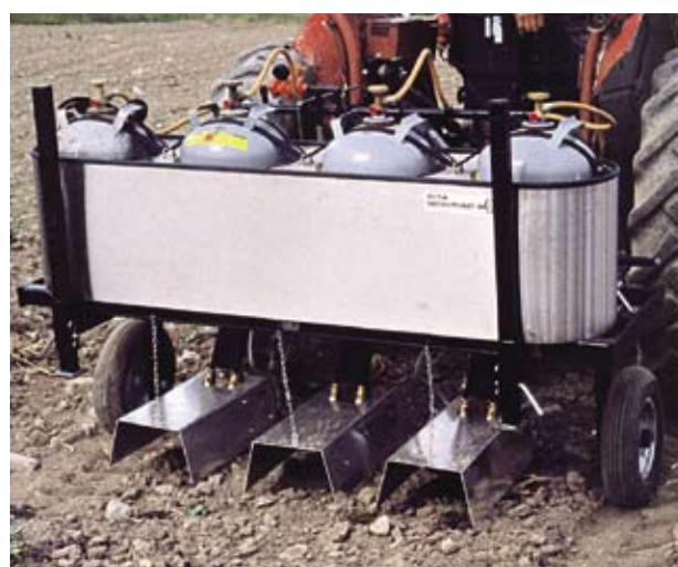
Figur 1.33 'Thermec B bandflammere' med propanflasker i oppvarmet vannbad. Foto: Johan Ascard.
