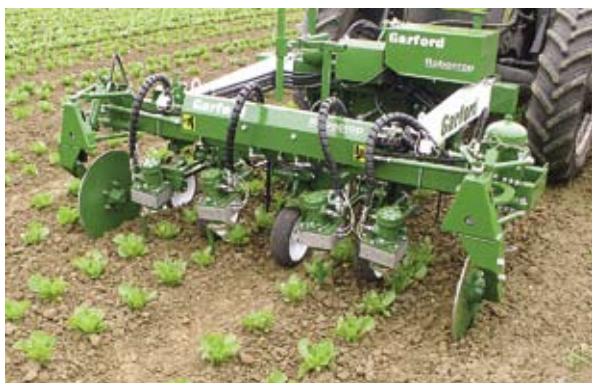
Figur 1.62 Nytt mekanisk utstyr som styres ved hjelp av maskinsyn til bruk i raden. Foto: Garford Farm Machinery.
