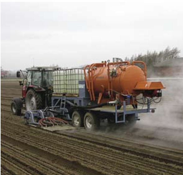
Figur 1.60 Traktoråren REGERO-maskin for damping av senger. Foto: Johan Ascard.
