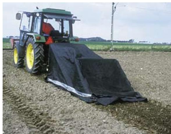
Figur 1.12 Jordarbeiding i mørke gir ofte redusert ugrasspiring. Man behøver ikke kjøre om natta, men kan gjøre dette om dagen dersom redskapen er skikkelig tildekt med et lystett materiale. Foto: Johan Ascard.
