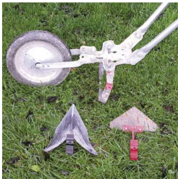
Figur 1.53 Nærbilde av hjulhakke med diverse typer arbeidsorgan. Foto: Lars Olav Brandsæter.
