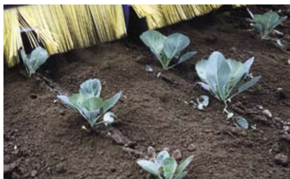
Figur 1.44 Radbørsten fra Baertschi-Fobro har god effekt mot ugras mellom planteradene selv under noe fuktige forhold. Foto: Reidar Holmøy.
