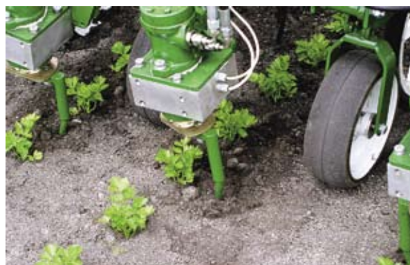
Figur 1.62 Nytt mekanisk utstyr som styres ved hjelp av maskinsyn til bruk i raden. Foto: Garford Farm Machinery.
