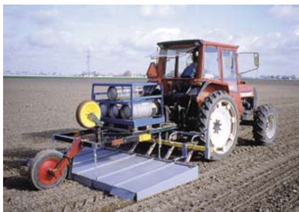
Figur 1.35 Ved stripeflamming med en brenner per rad, men med et deksel over alle, reduseres gassforbruket sammenlignet med bredflamming. Bildet viser en prototyp som er utviklet av JTI og Danisco Sugar. Foto: Johan Ascard.
