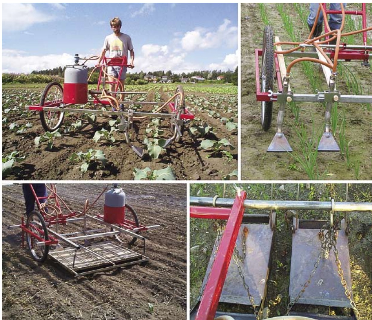
Figur 1.31 Hånddrevet redskap på hjul for selektiv flammning fra Elomestari i Finland. Foto: Petri Leinonen.
