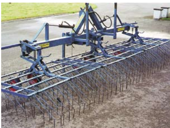
Figur 1.50 Bildet viser en ugrasharv fra Køckerling med harvseksjonene opphengt i parallellgram og med støttehjul på hver seksjon. Foto: Johan Ascard.
