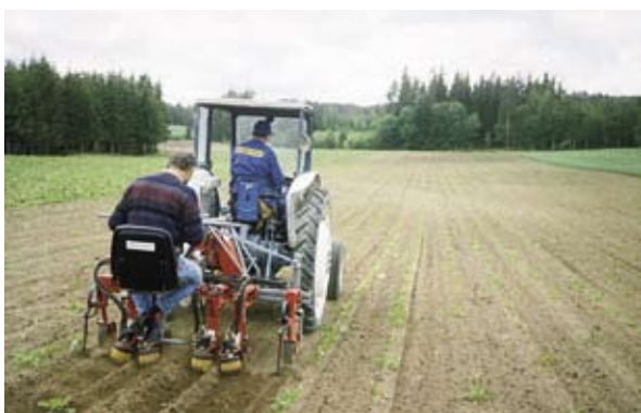
Figur 1.43 Børstemaskinen Thermec B har god effekt mot ugras og kan arbeide mye nærmere raden. Den er imidlertid dyrere og har lavere kjørehastighet enn en vanlig radrenser. Foto: Reidar Holmøy.
