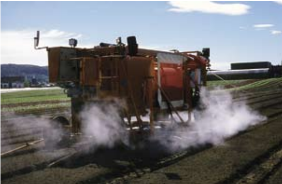
Figur 1.59 REGERO-maskin for grunndamping i isbergsalat - Lier 2001. Foto: Helge Sjørusen.
