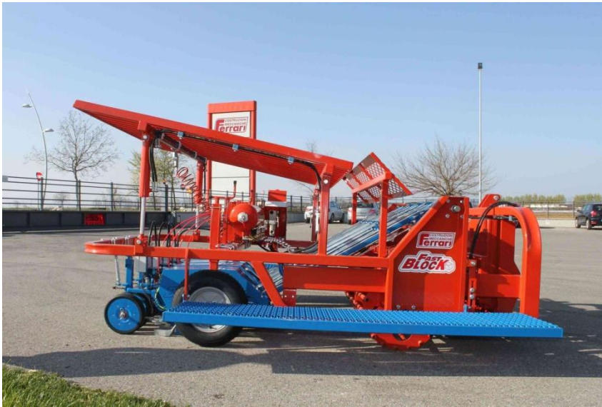
Figura 3.2.24 Plantadora automática de lechuga
