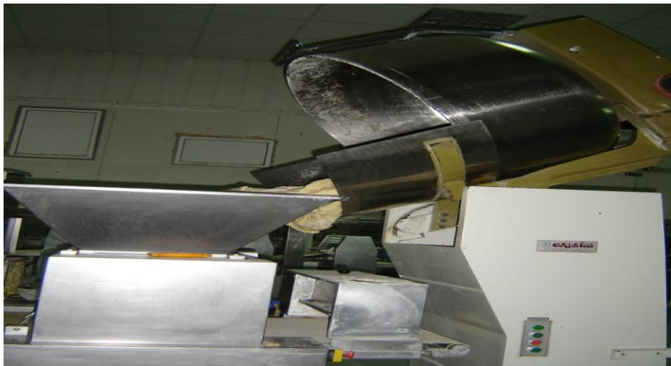
Εικόνα 3: Μεταφέρεται το ζυμάρι στον εξωθητή με ανατροπή
