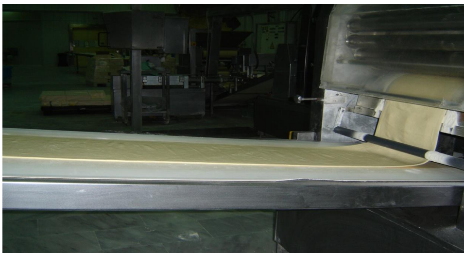
Εικόνα 4: Η μορφοποίηση του ζυμαριού σε φύλλο
