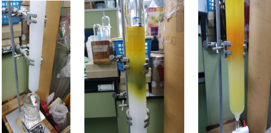
รูปที่ 18 แสดงการแยกสารด้วย Column chromatography
