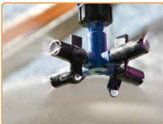
Foto 5. Sistema de nebulización automática bajo invernadero y micro-túneles.
