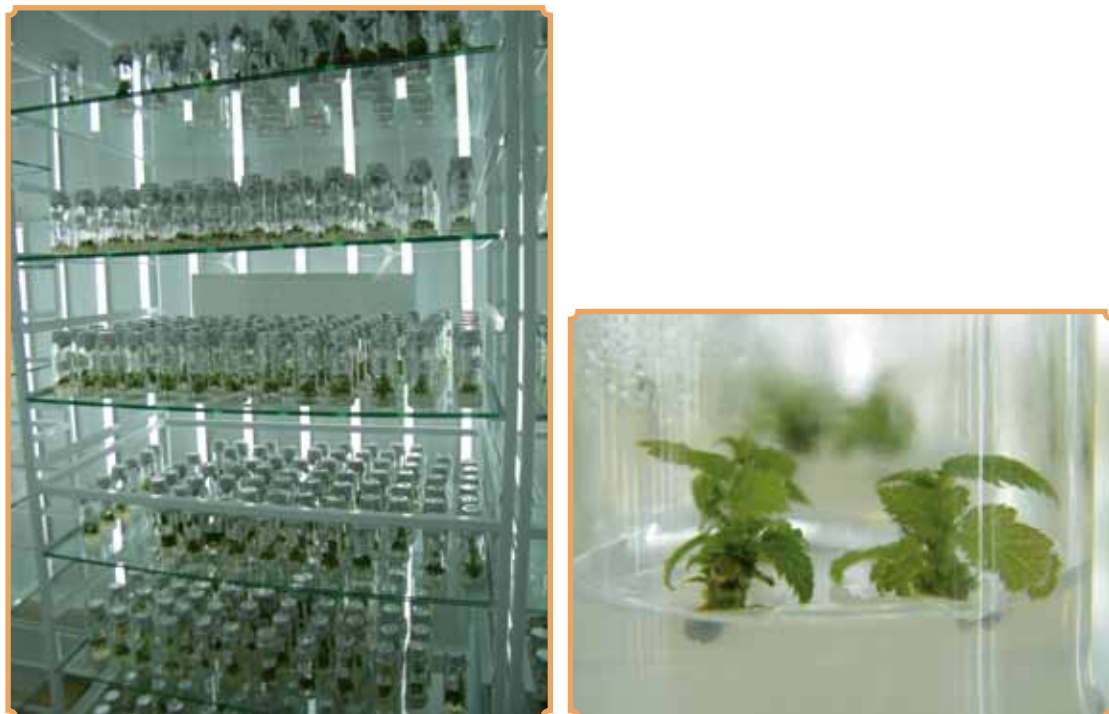
Foto 15. Cámara de crecimiento climatizada con material de avellano en proliferación (Laboratorio de Fruticultura INIA Carillanca).
