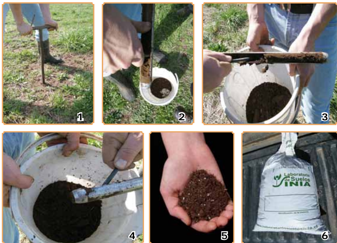
Fotomontaje 1. Procedimiento para el muestreo de suelo.
