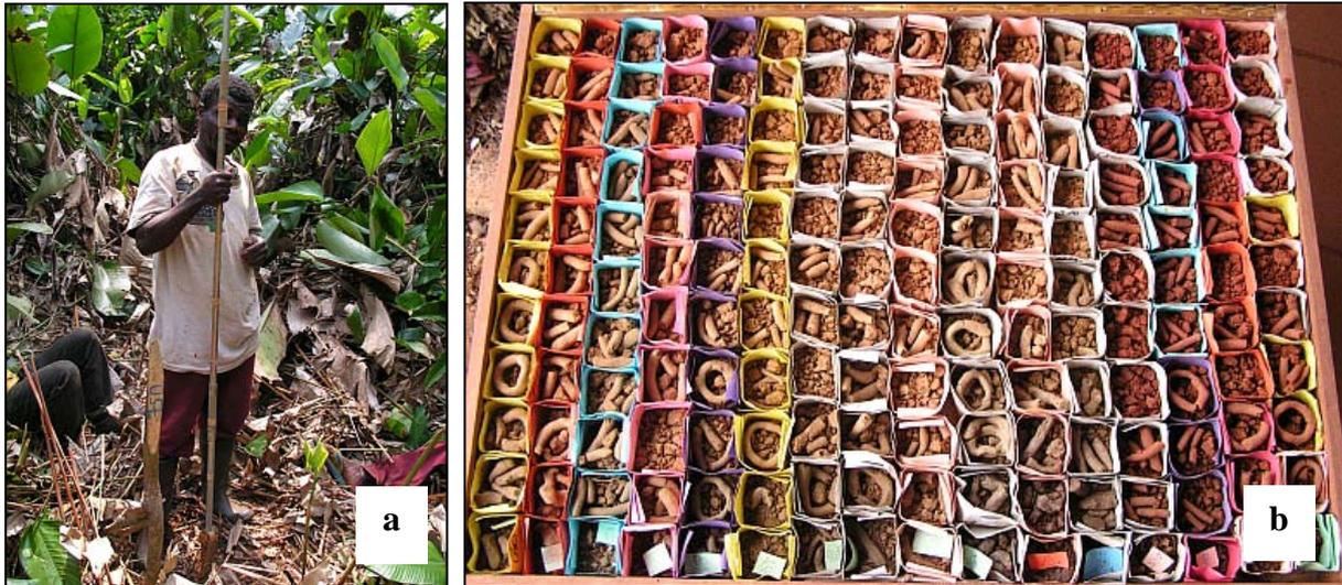
Figure 29 : a) Sondage à la tarière pédologique, b) Pédocomparateur (colonnes = sondages, lignes = profondeurs). Onze profondeurs sont systématiquement prélevées (de bas en haut) : 5 premiers centimètres (litière) et tous les 20 cm, de 20 cm à 2 m.
