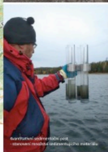
Wektýřová sedimentační past - sběr materiálu pro analýzu kvalitativní
