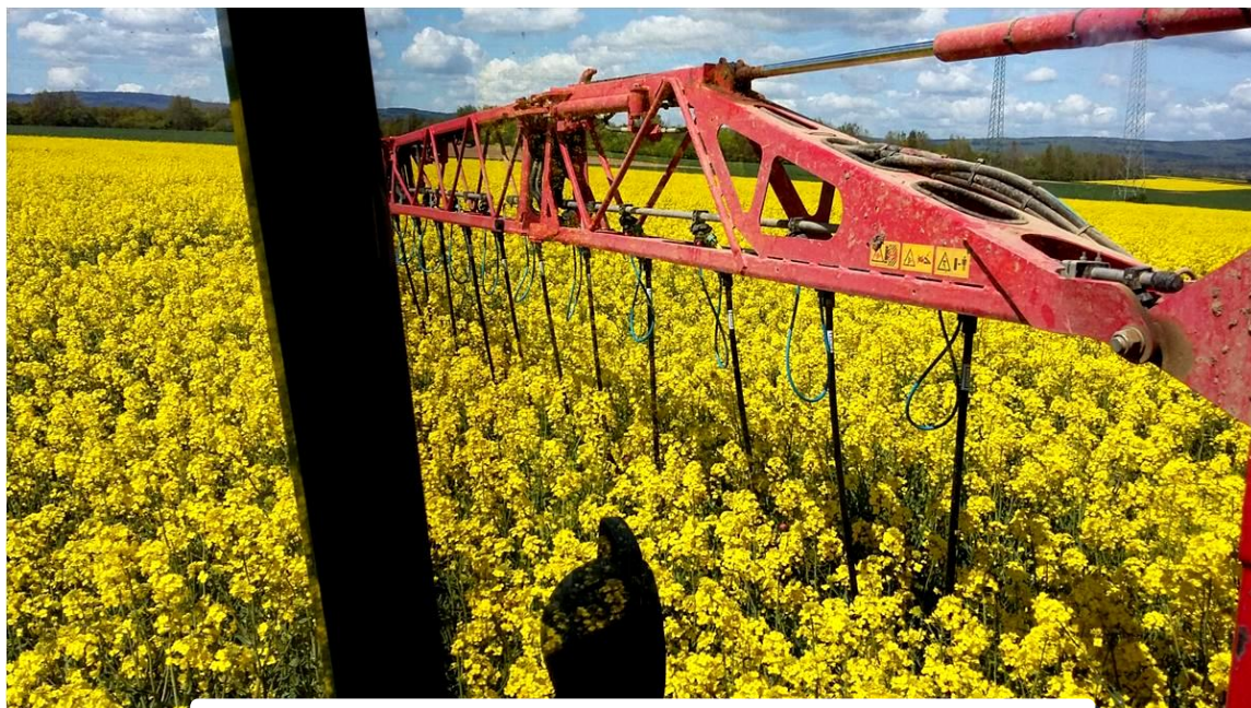
Applikation der Droplegvarianten (Bild vom Schlepper aus)
