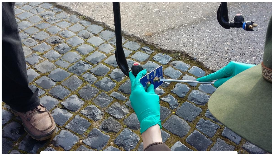
Einstellung der Droplegdüsen mit Schablone
