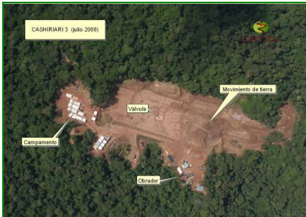
Figura 11. Fotografía Aérea Plataforma Cashirairi 3 en julio de 2008. Recién se estaban comenzando los movimientos de tierra para preparar la plataforma para el equipo de perforación.
