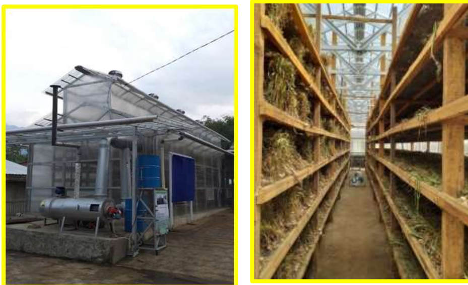
Gambar 79. Instore dryer untuk curing bawang putih di dataran tinggi
