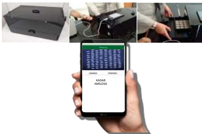
Gambar 88. Perangkat dan tampilan aplikasi antar muka deteksi cepat mutu beras
