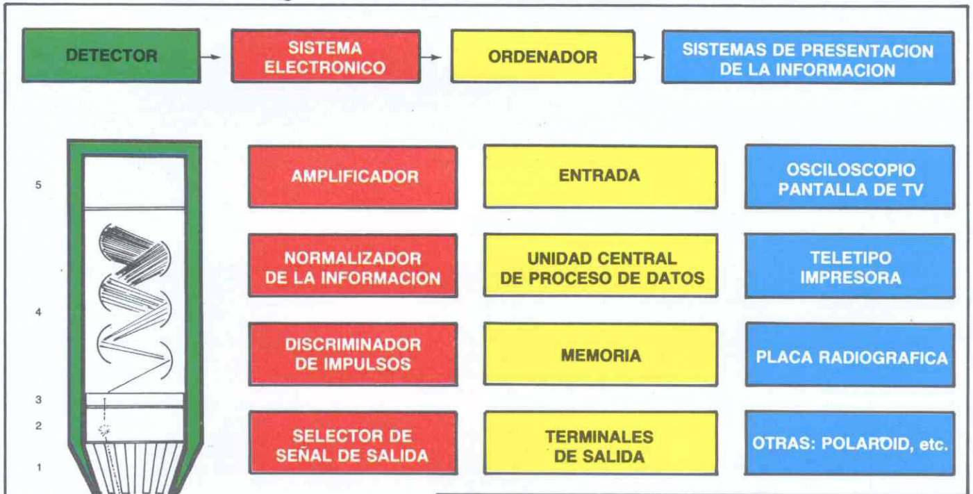
Figura 2.—1. Colimador: Dispositivo blindado, que tiene la misión de limitar el campo de visión del detector, de modo que la radiación emitida por otros puntos no sea detectada. 2. Cristal de centelleo: Para radiación gamma se emplea el constituido por yoduro sódico activado con Talio. Transforma el rayo gamma incidente en un fotón luminoso, por ionización y excitación molecular. 3. Tubo Fotomultiplicador: El fotón luminoso incide sobre el fotocátodo (3), donde arrastra, por efecto
