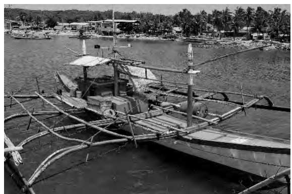
図11-15 大型パンカのアウトリガー (Cabugao)
