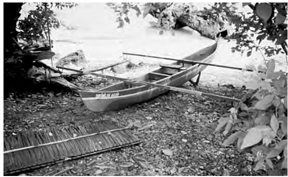
図8-34 インドネシア・中部マルク・アンボン島付近のダブルアウトリガー舟
