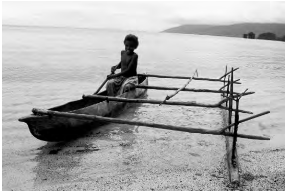
図7-3 間接結合法のシングル・アウトリガー式カヌー： PNG ビスマルク諸島ニューアイルランド島
