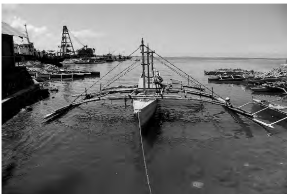
図11-14 大型パンカのアウトリガー (Cabugao)
