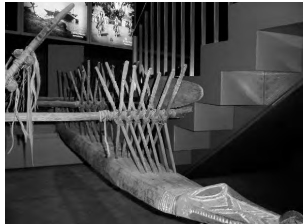
図8-3 籐によるショーテン諸島カヌーアウトリガーの結縛(海洋文化館蔵展示資料)
