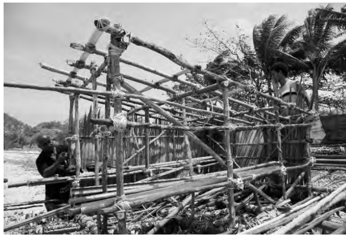
図8-6 籐によるラカトイの部材の結縛：PNG 国ポートモレスビー付近独立記念日祝祭用のラカトイ型カヌー
