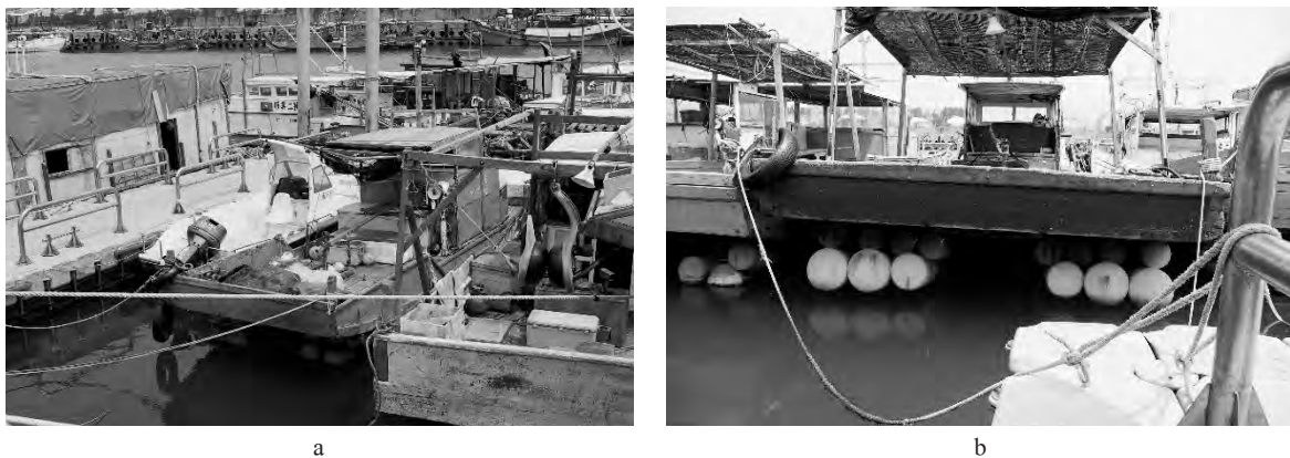
図5-33 台湾東海岸成功港における塩ビパイプ式漁船
