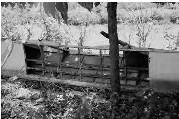
図11-4 バンカの合板製船体の骨組み (Davila)
