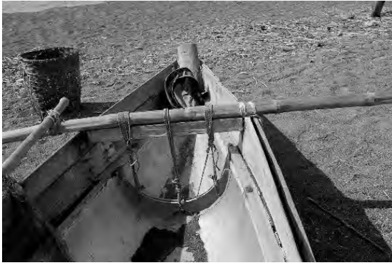
図11-6 アルミ製船底をもつバンカの内部と腕木の結縛 (Badoc)
