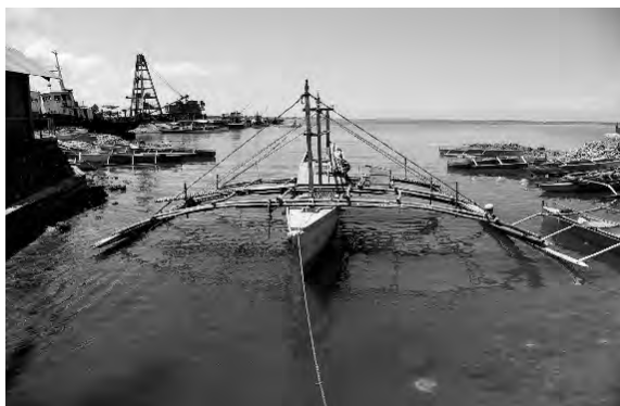
図7-5 複数の竹を束ねたカヌー漁船：フィリピン・ルソン島・イロコス地方
