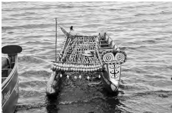
図8-9 蔦で結縛されたクラ型カヌー (アロタウのカヌーフェスティバル)
