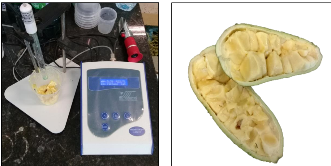
Figura 4. Leitura direta para determinação do pH com o uso do peagômetro digital.
