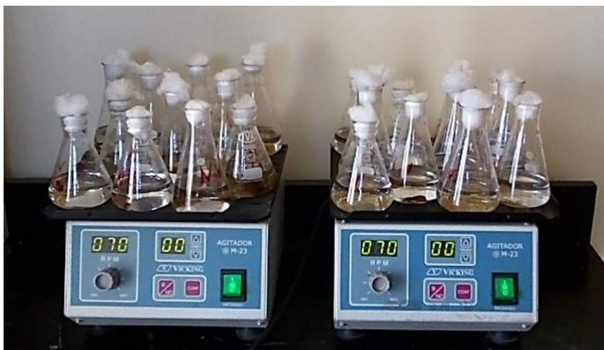
**Figura 2.4.** Erlenmeyers en agitación, en uno de los experimentos de esporulación.
