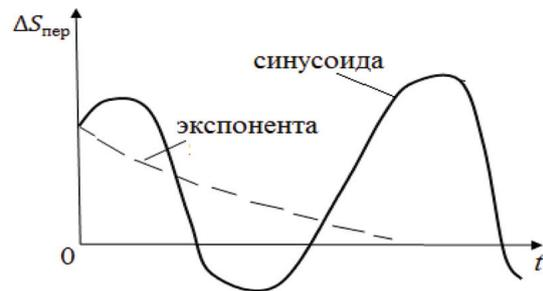
Рис. 3. Неустойчивый переходной процесс системы
