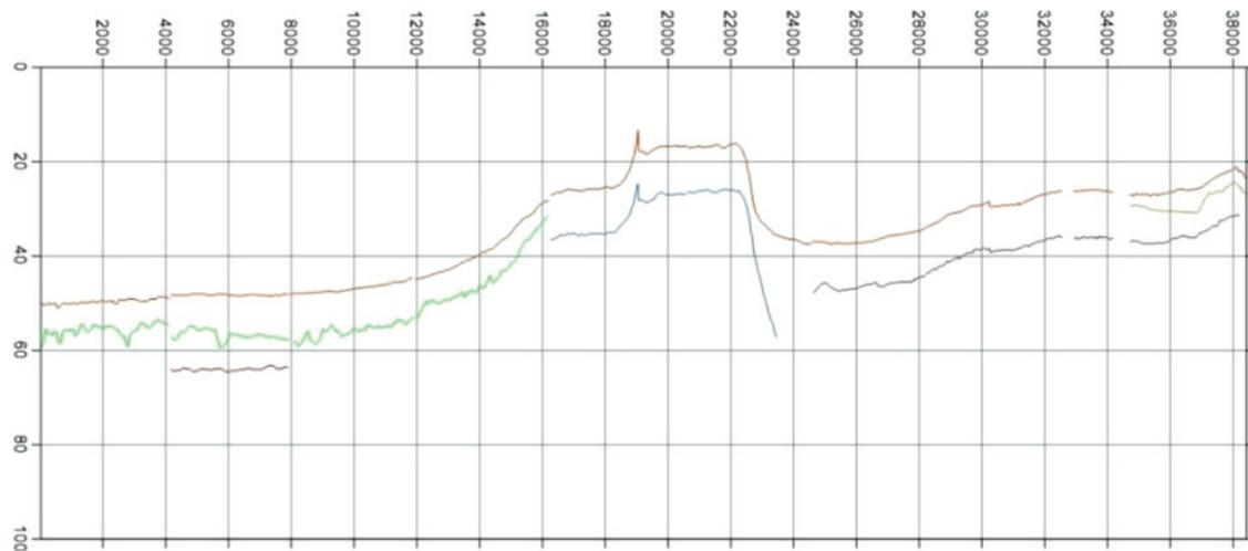
*Рис. 2. Сводное изображение, выделенных при первичном дешифрировании отражающих границ. Шкала расстояния от начала разреза и шкала глубин заняли привычные места – расстояния по горизонтали, глубины по вертикали. Обе шкалы в метрах*
