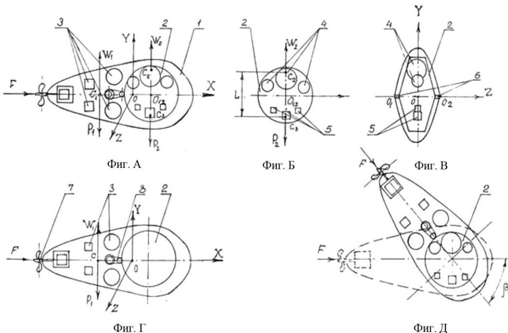
Рис. 1. Цифровые обозначения 1–8 – элементы внутренней конструкции, буквенные обозначения указывают на оси координат и строительные оси аппарата, а также на вес и объем
