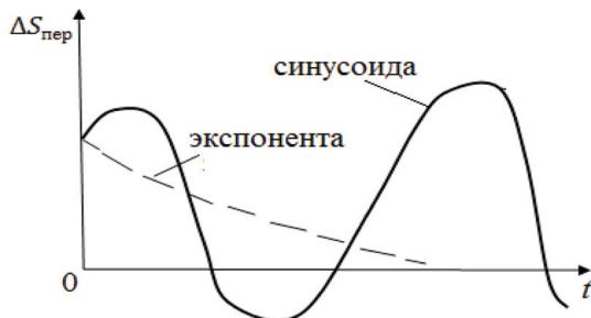
Рис. 3. Неустойчивый переходной процесс системы
