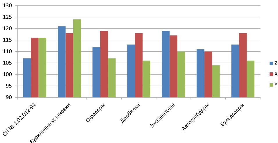
Рис. 2. Оценка уровня вибрации по среднегеометрическим частотам
