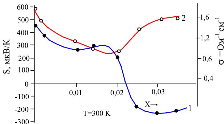
Рис. 1. Зависимости термо-э.д.с. (S) и электропроводности от состава в твердых растворах  $Ce_xSn_{1-x}Se$   $T = 300$  К. 1 – термо-э.д.с. (S); 2 – электропроводимость ( $\sigma$ )
