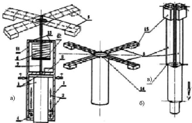
Рис. 3. а) и б) показана схематично цилиндрическая конструкция устройства переменного водоизмещения 1 для реализации способа в двух видах действия способа: вида а) в разрезе, б) на поверхности воды, а при погружении или всплытии в толще воды – в)
