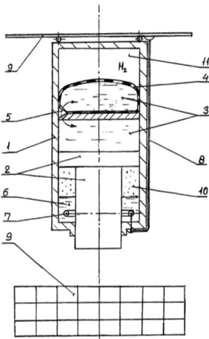
Рис. 2. Вариант схемы способа управления водоизмещением с помощью изменения объема жидкости, подогреваемой за счет солнечной энергии
