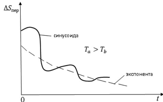
Рис. 2. Переходной процесс в системе при  $T_a > T_b$
