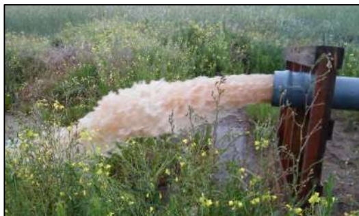
Fotografías 8.4 y 8.5. Caudal con presencia de abundante arena – Ensayo pozo P5.
