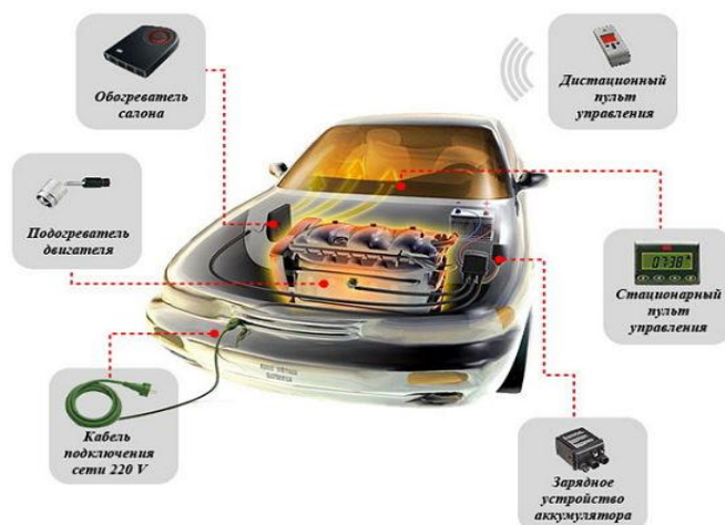
Рисунок 2 Устройство и схема расположения электрического подогревателя двигателя
