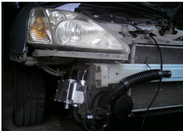
Рисунок 4 - Подключение устройства для запуска топливного подогревателя
