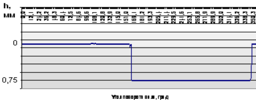
Рис. 4. Отметки углов закрытия и открытия впускного клапана
