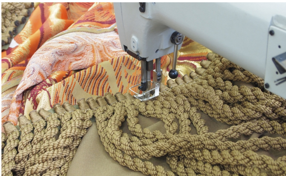
Рис. 7 Соединение бахромы с основным занавесом
