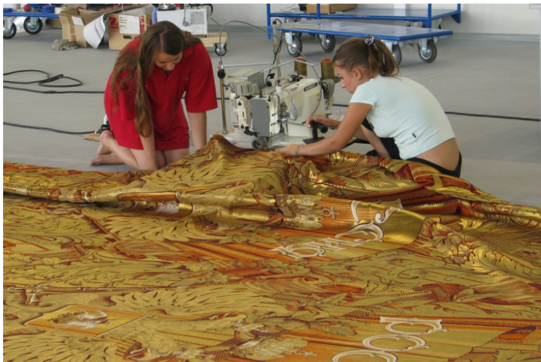
Рис. 5 Обработка боковых сторон занавеса на напольной машине
