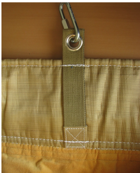
Рис. 6 Обработка верха занавеса и фиксация подвесов
