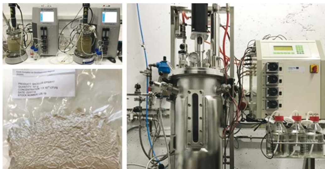
Figura 4. Biorreactores empleados para el escalado y producción semiindustrial de microorganismos para la formulación de bioplaguicidas, y prototipo de formulación envasada al vacío en formato de polvo mojable WP (Imágenes de Emilio Montesinos).
