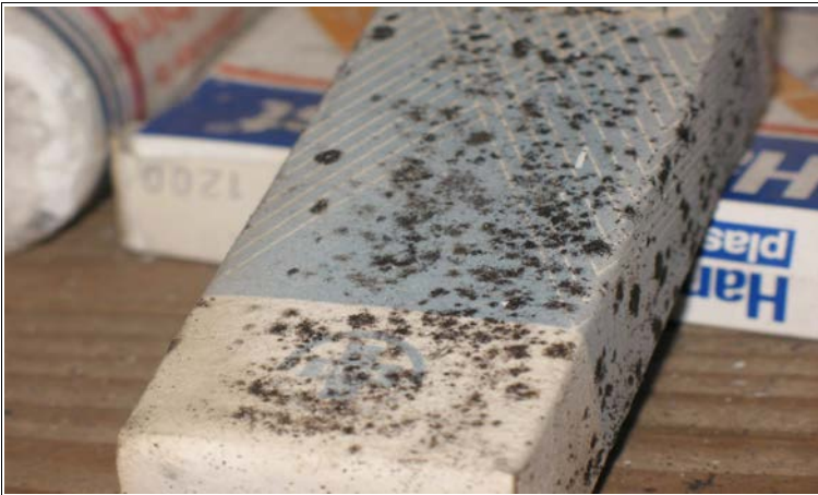
Figur 4. På grunn av høy relativ luftfuktighet i bygninger uten permanent oppvarming, kan det vokse kondensmuggsopper ( Cladosporium sp.) på ulike overflater.
