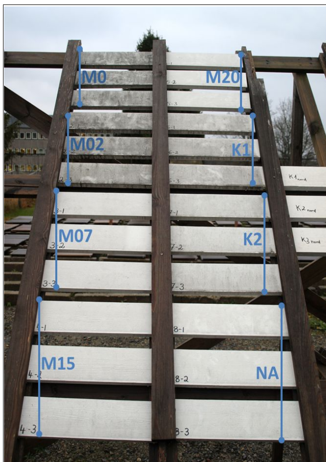
Figur 3. Svertesoppvekst på testmalingene etter 13 måneder utendørs eksponering. M0=modellmaling 0, M02=modellmaling 02, M07=modellmaling 07, M15=modellmaling 15, M20=modellmaling 20, K1=maling K1, K2=maling K2, NA=prøvepaneler ikke med i testen.
