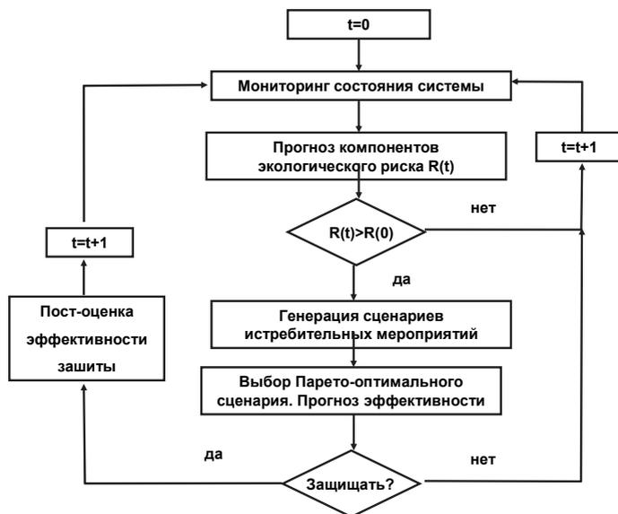
**Рис. 4.** Общая схема процесса принятия решения при планировании и проведении защитных мероприятий
