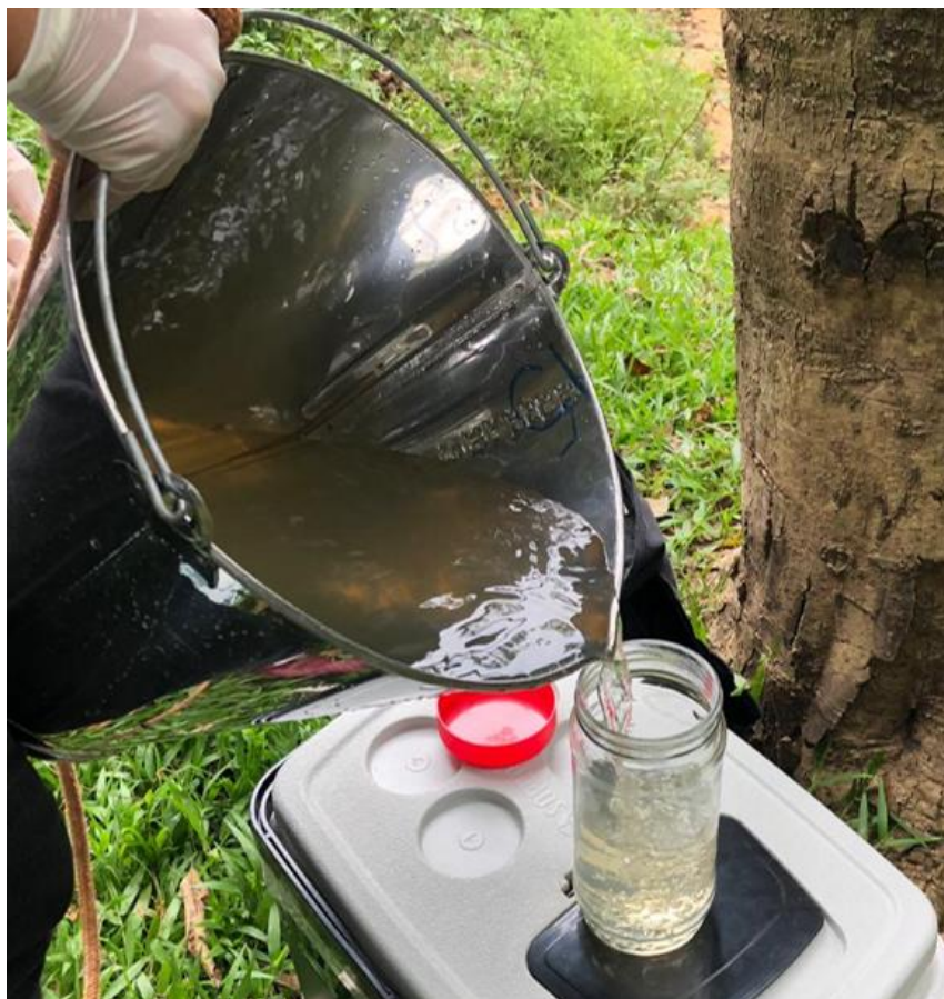
Figura 3. Coleta de águas superficiais com auxílio de balde inox acoplado a corda. Fonte: Arquivo pessoal
