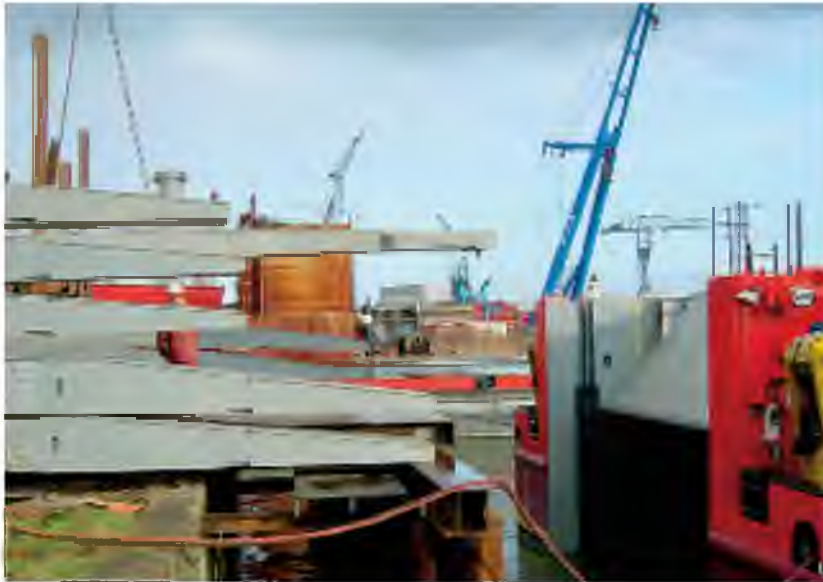
Figuur 4: Achterschip, met de bevestigingsbalk voor de losse landingskleppen die op de wal gereed liggen (foto: Damen Shipyards)
