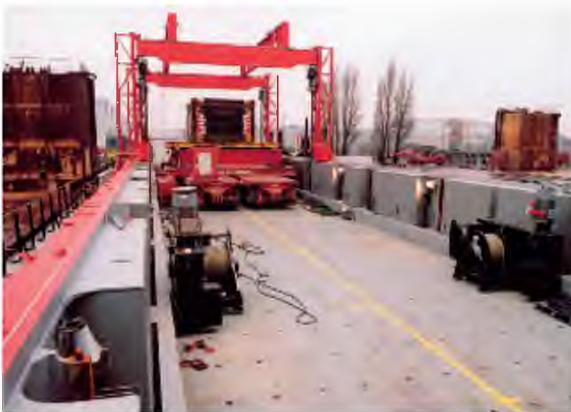
Figuur 5: Gezicht op het platformdek, met vooraan de laadlieren (foto: Damen Shipyards)
