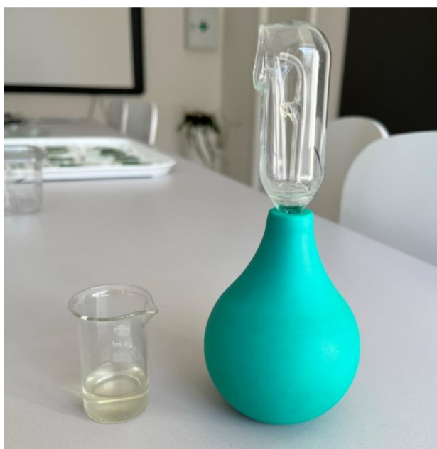
Obrázek 6: Skleněný rozprašovač a kádinka s roztokem, které jsem využila pro inokulaci patogenu Peronospora destructor na segmenty listů a rostliny cibule kuchyňské ( Allium cepa ).
