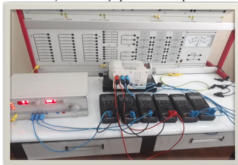
7- rasm. Uch fazali elektr zanjirlarni oddiy qarshiliklar orqali uchburchak ulash sxemasi.
