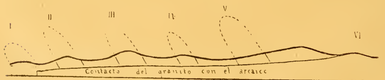
CORTE QUE MUESTRA LA MANERA CÓMO EL GRANITO CORTA LOS PLIEGUES DEL ARCAICO EN LAS CERCANÍAS DE SAN ILDEFONSO.
