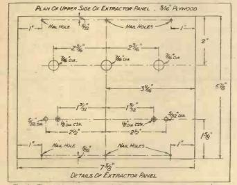
TRIPLE EXTRACTOR DRILLING DETAILS
