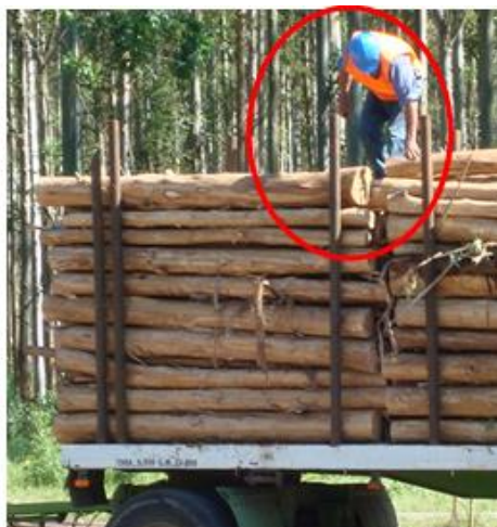
Figura 7-22: Conductor de camión caminando por encima de la carga, acto peligroso, con riesgo de caída de altura. Foto: Gabriel Cardozo.
