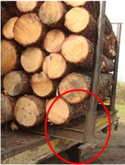
Figura 7-21: Desplazamiento de carga del camión por condición peligrosa de apoyo del portaestaquera sobre la superficie plana del camión. Foto: Gabriel Cardozo.
