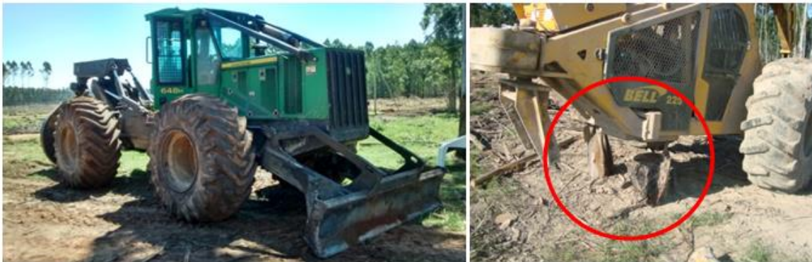
Figura 7-19: Máquina estacionada con sus implementos apoyados sobre el suelo (izquierda); máquina apoyada de manera peligrosa sobre tacos de madera, sin señalización (derecha). Fotos: Gabriel Cardozo.
