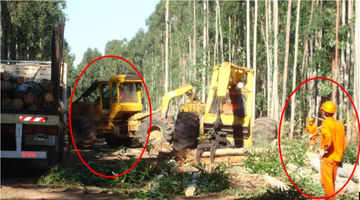
Figura 7-20: Faena de carga con interferencias de personas y equipos, situación que puede desencadenar en un grave accidente. Foto: Gabriel Cardozo.
