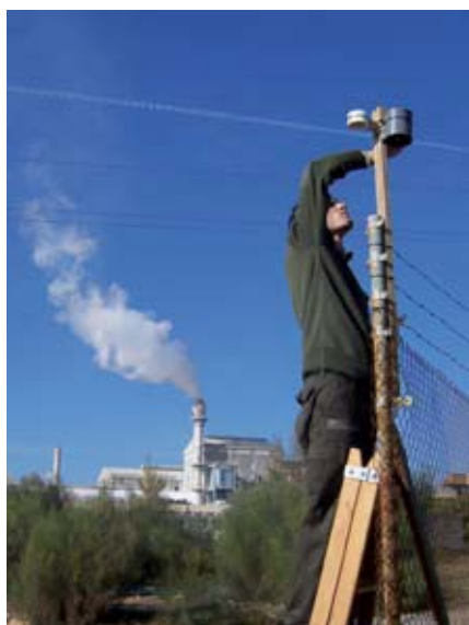
Colocación de captador difusivo en campo
