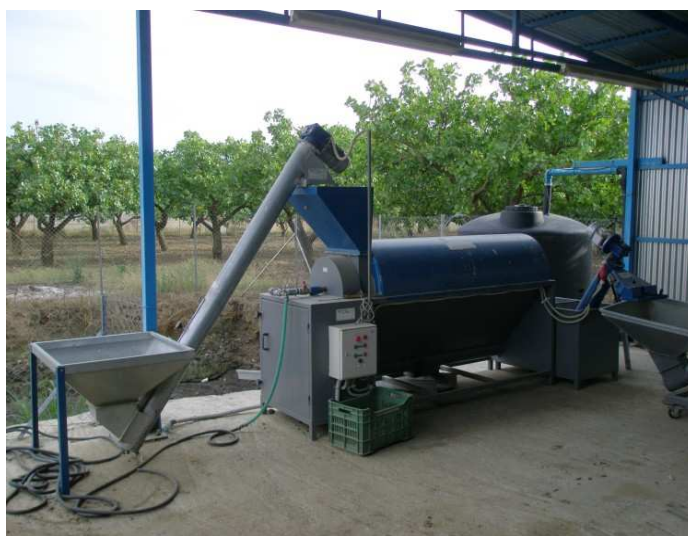
Εικόνα 32. Μηχάνημα αποφλοιώσης φιστικιών (αποφλοιωτήριο).
