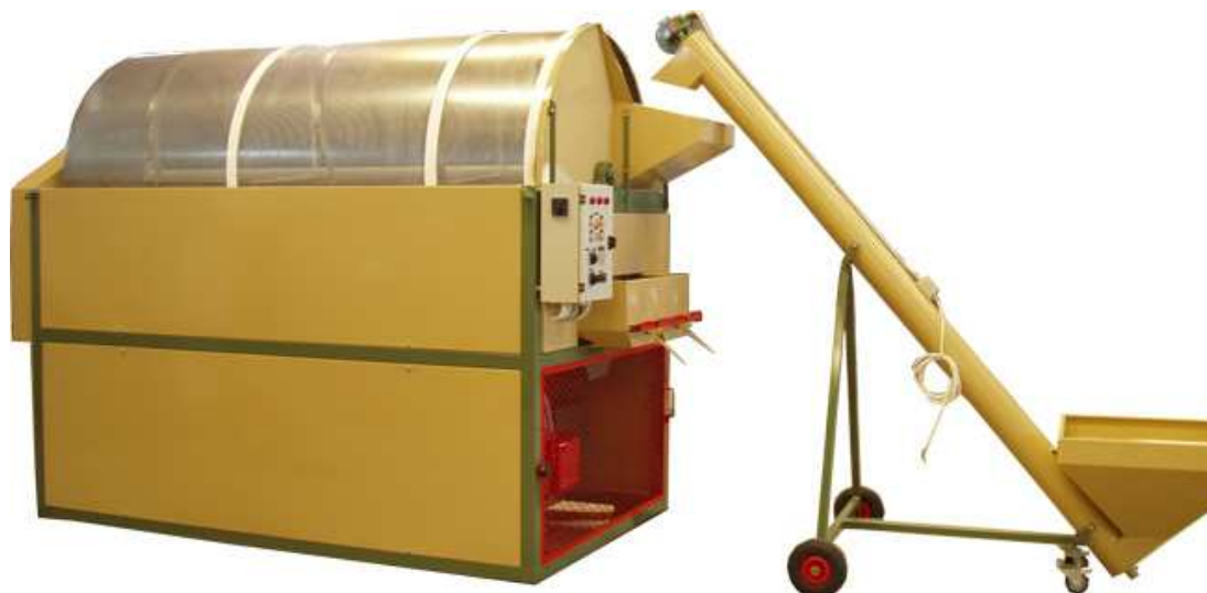
Εικόνα 35. Ξηραντήριο φιστικιών.(φιστικοπαραγωγού Μάκρης-Φθιώτιδας)
