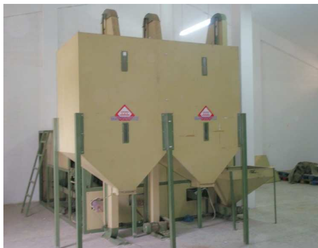
Εικόνα 37. Διαλογέας φιστικιών. (Πηγή από Αγροτικό συνεταιρισμό Μάκρης-Φθιώτιδας).
