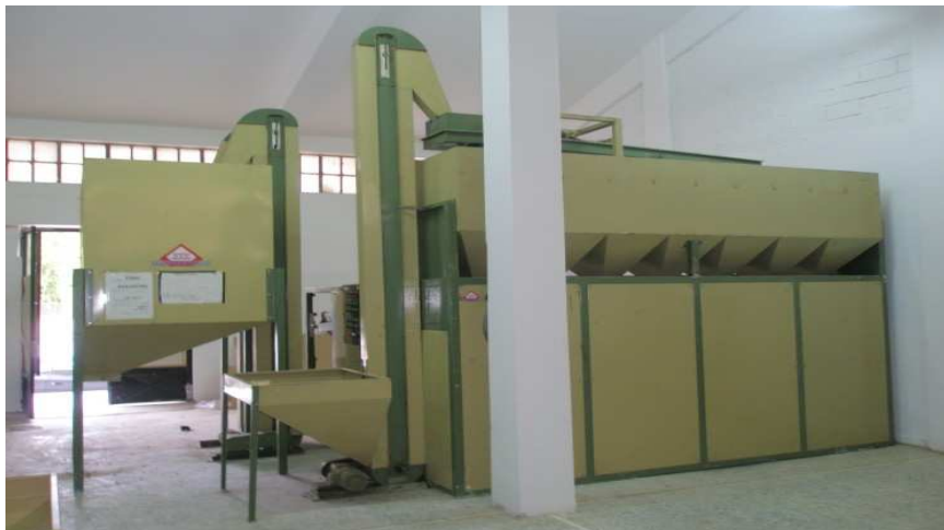
Εικόνα 36. Διαλογέας φιστικιών. (Πηγή από Αγροτικό συνεταιρισμό Μάκρης- Φθιώτιδας ).
