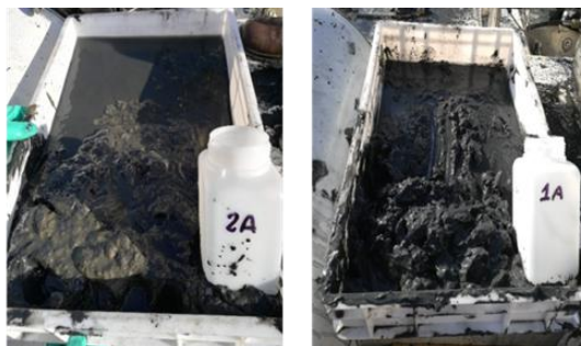
Figura 2.40 Campioni di sedimento prelevato per analisi chimiche batteriologiche ed ecotossicologiche.
