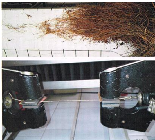
Figura 3.10 La caratterizzazione morfologica e meccanica delle radici è stata effettuata presso il Laboratorio di Ricerca Sperimentale – Sezioni Materiali e Strutture (Laboratorio Ufficiale dello Stato Italiano art. 20 Legge n.1086 del 05/11/1971) ed è stata certificata (Certificato n 15060XX00003 del 09/11/2015).
