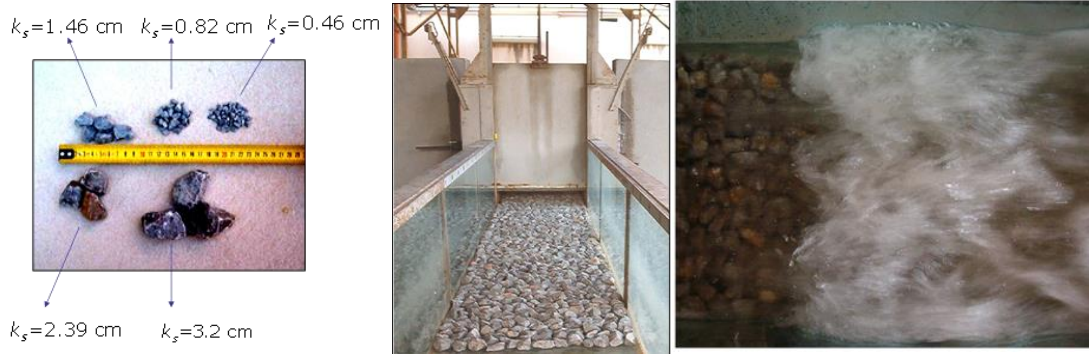
Figura 4.8 Canaletta ed elementi in ghiaia utilizzati per lo studio del risalto idraulico su fondo scabro.
