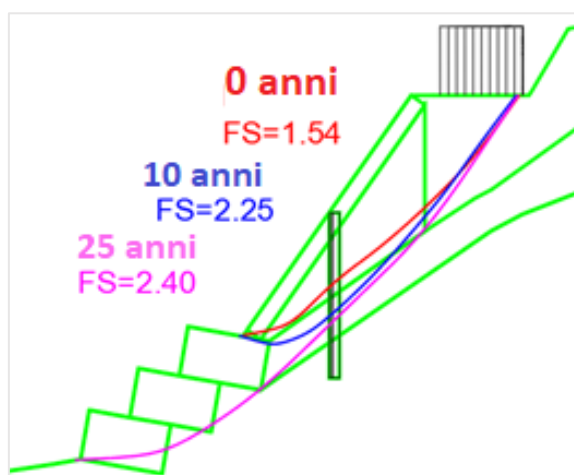
Figura 7.14 Superfici di scivolamento ai vari istanti temporali.
