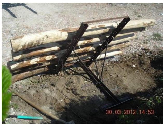
Figura 3.52 Prove di carico su loricata . Area sperimentale Pavona (RM) (foto Marrone E.).
