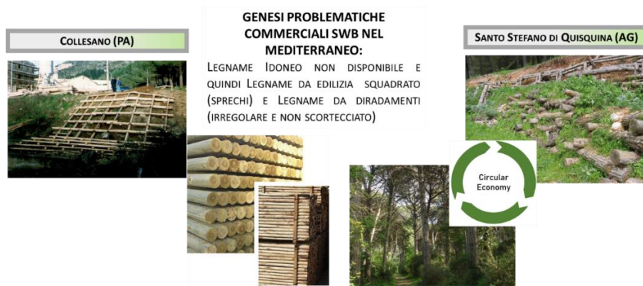
Figura 1.10 Esempio di dicotomia dell'IN: Utilizzo di legname scortecciato, di difficile reperibilità specialmente in ambito mediterraneo, all'impiego di legname irregolare da recupero in loco.
