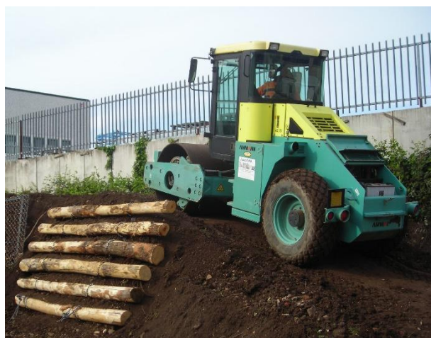
Figura 3.52 Prove di carico su loricata . Area sperimentale Pavona (RM) (foto Marrone E.).
