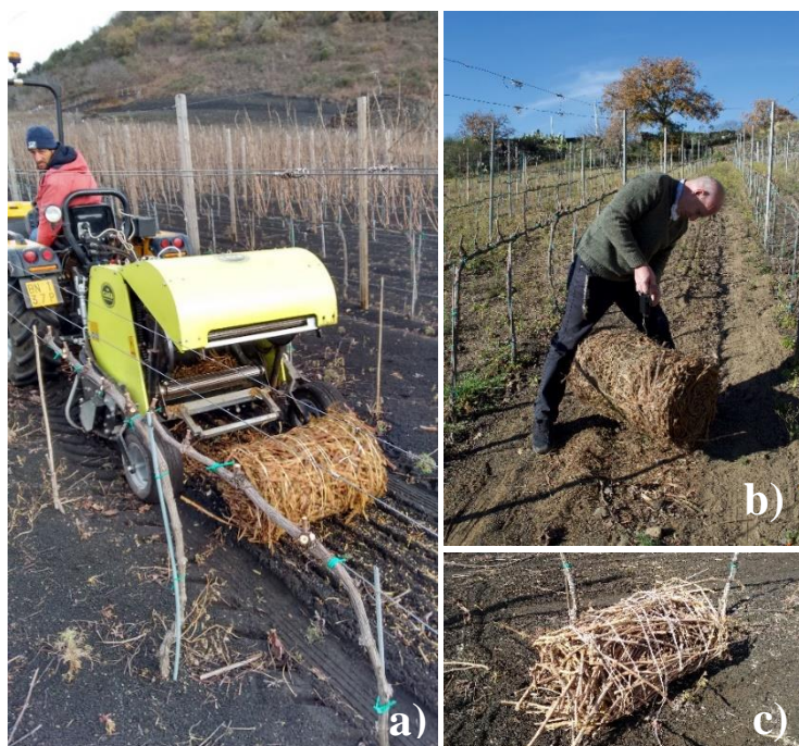
Figura 3.66 a) Raccolta sarmenti e produzione RFM con rotoimballatrice CAEB, b) pesa delle RFM, c) RFM a bassa densità (100 kg/m 3 ).
