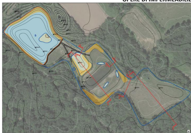
Scheda 39: in azzurro l'area impermeabilizzata. La profondità media al massimo invaso di circa 120 cm è stata ora recuperata per una porzione importante (ovest) del Lago Vecchio per una superficie di 8.604 mq. Precedentemente agli interventi la profondità media (minimo invaso) era ridotta a circa 30 cm. con una notevole evapotraspirazione e a notevole moria di fauna ittica.
