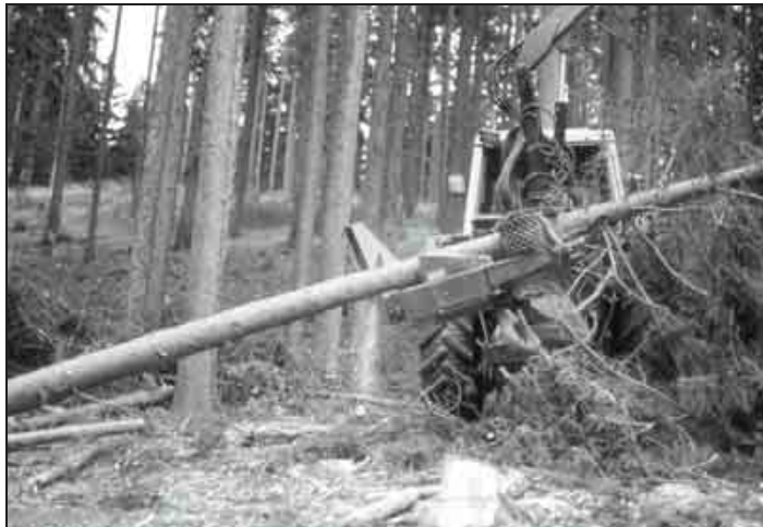
Figura 5. Operazione di allestimento meccanizzato con testa allestitrice applicata a trattore agricolo (Foto S. Balini).
