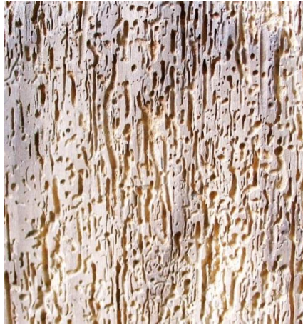
Fig.111. Galeriale de Anobium punctatum urmează, în general, direcția fibrelor lemnului dar, spre suprafață, galeriile devin neregulate (după Moșneagu M., 2009)
