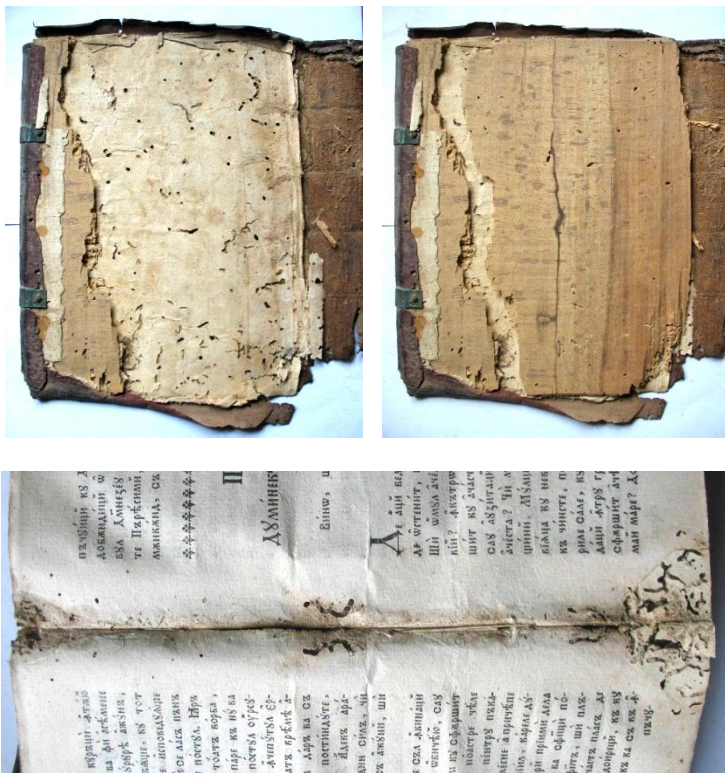
Fig.158. Deteriorări provocate de Anobium punctatum asupra lemnului, hârtiei și pielii (după Moldovan G., 2007)
