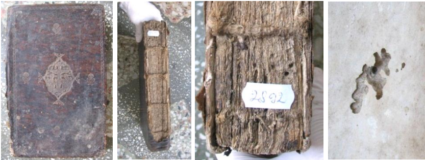
Fig. 165. Deteriorări provocate de larvele și adulții speciei Ptinus brunneus asupra hârtiei, cartonului și pielii (după Moldovan G., 2007)
