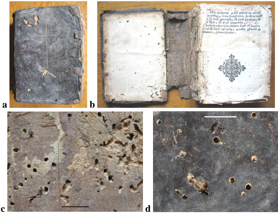
Fig. 159. Detalii privind atacul speciei Anobium punctatum : vedere de ansamblu a primei coperti (a), a doua copertă deschisă (b), lemnul primei coperti cu orificii și galerii sub piele (c) și pielea perforată de către adulți (d) (segmentele reprezintă 10 mm) (după Moldovan G., 2007)
