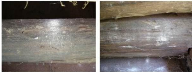
Fig.136 – Aspecte ale atacului speciei Lyctus linearis Goeze. (Col. Lyctidae), (după Ungurean B., 2011) a), b), d) atac instalat în lemn de ulm ( Ulmus minor Mil.) c) macrofotografie cu aspectul rumegușului produs în urma atacului
