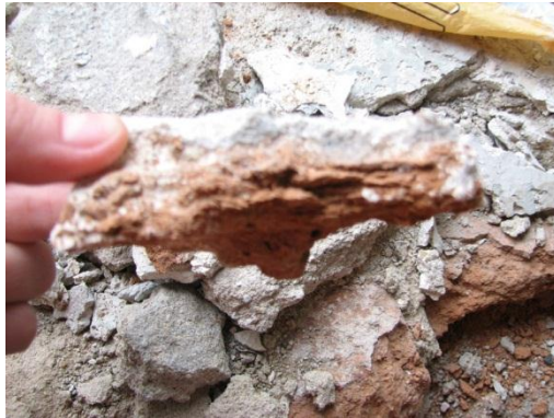
Fig. 93. Lemn acoperit de miceliul speciei Serpula lacrymans (original)
