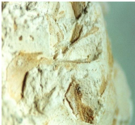
Fig. 195. Macrofotografie (efectuată la stereolupă, pe o secțiune de 5 mm 2 ), ce evidențiază structura stratului de intonaco – prezența materiilor vegetale (paie), în amestec cu var. (după B. Ungurean, 2004)
