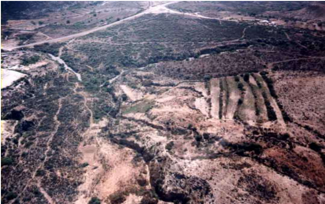
En la región abundan las pequeñas obras de minería a pequeña escala, algunas reactivan jales y minas antiguas, en la foto, presa de jales al lado de un arroyo. Riesgos de desborde hacia el cauce.
