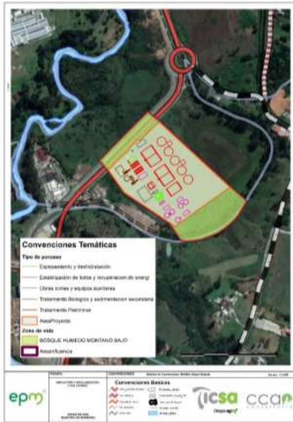
Imagen 2: Plano del diseño del proyecto PTAR TRANVIA. *Tomado de la solicitud.
