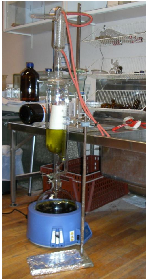
Figur 5-1: Ekstraksjon med organisk løsemiddel ved hjelp av Soxhlet-oppsett.
