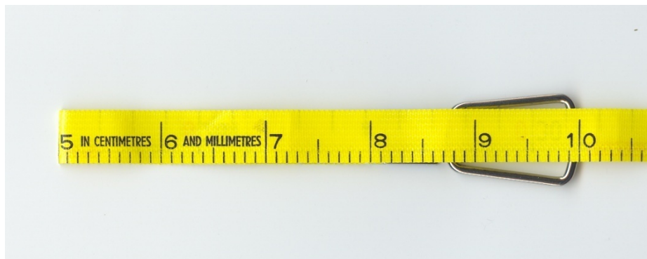
Figure 5 : Vérification du point « 0 » du mètre ruban.
