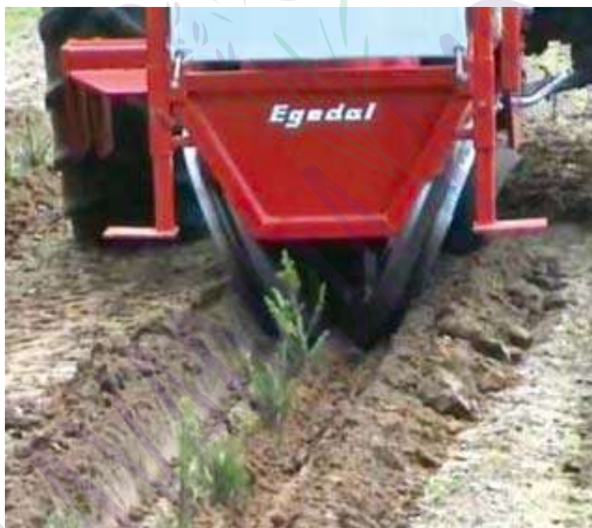
Figura 20. Săditul lavandei mecanizat, cu tasare.
