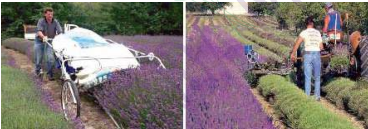
Figura 25. Culegător de recoltare a levănțicăi manual și tractat.
