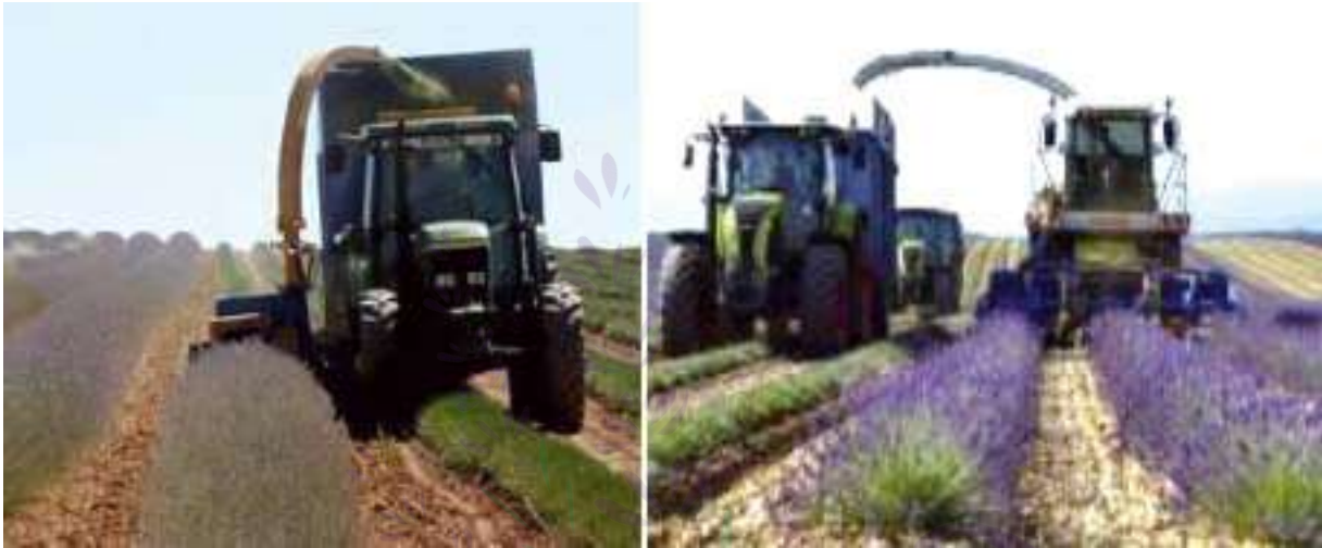
Fig. 27. Echipament specializat de recoltat lavanda cu toba de tocare pentru 1 rând (CLIER-1) și 3 rânduri.
