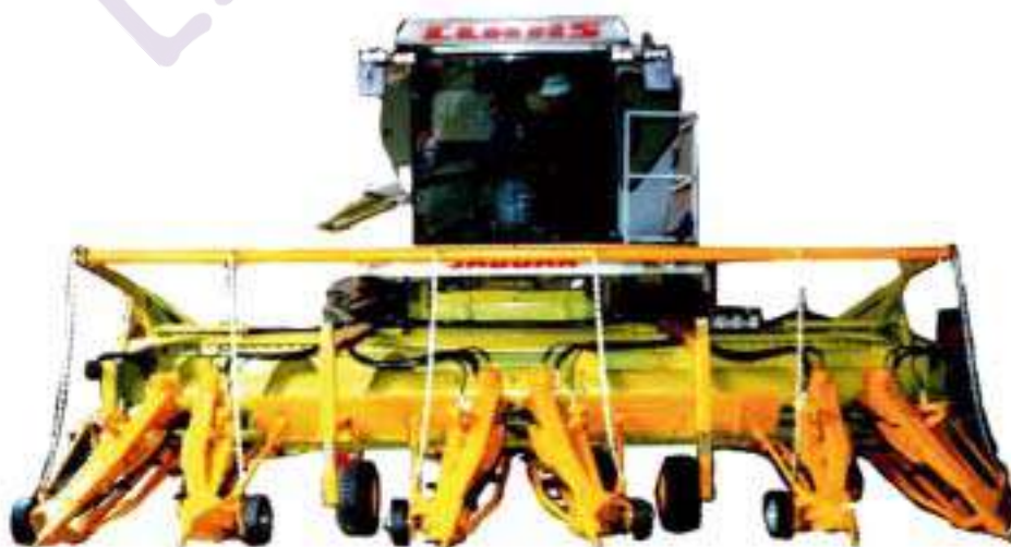
Fig. 26. Echipament specializat de recoltat lavanda pe 3 rânduri.
