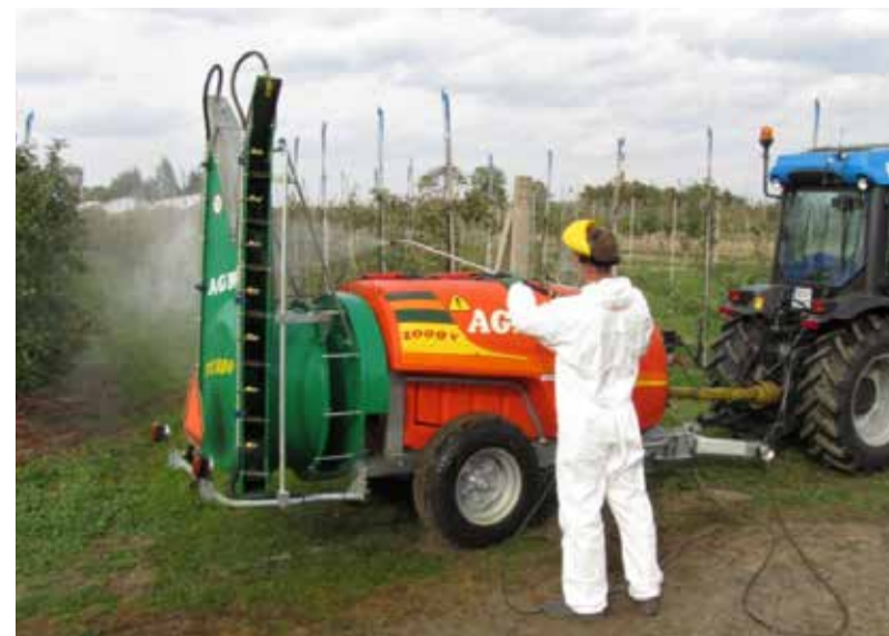
FIGURA 5. Esempio di lancia a mano collegata all'irroratrice per effettuare il lavaggio esterno direttamente in campo (foto: TOPPS - InHort).
