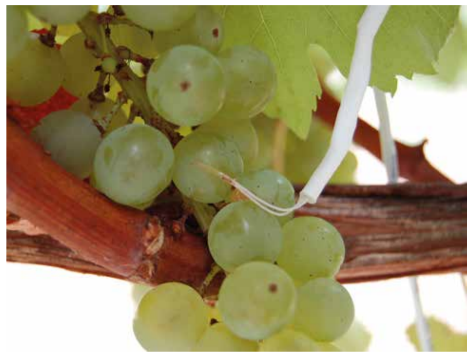
Foto 5. ► Particolare di una termocoppia inserita sotto l'epidermide di un acino per la rilevazione della temperatura
