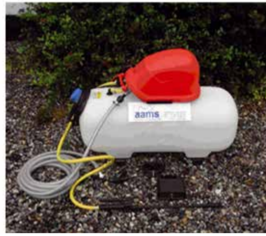
FIGURA 13. Esempio di serbatoio ausiliario per il lavaggio dell'attrezzatura equipaggiato con pompa elettrica dedicata grazie al quale è possibile effettuare il lavaggio interno dell'irroratrice azionando allo stesso tempo la pompa principale della macchina.
