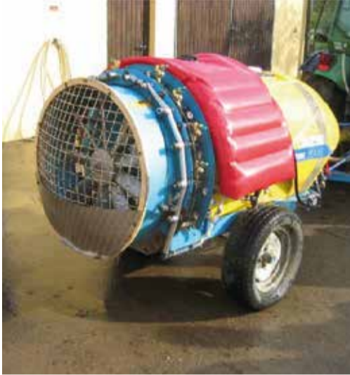
FIGURA 12. Esempio di serbatoio ausiliario per il lavaggio dell'attrezzatura montato su una macchina irroratrice originariamente priva di tale dispositivo.
