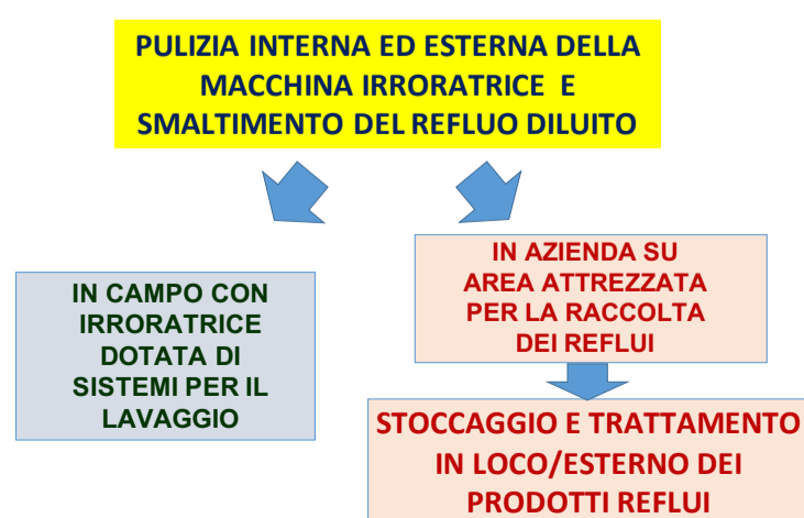
FIGURA 3. Schema delle scelte operative che può adottare l'agricoltore per gestire le operazioni di pulizia della macchina irroratrice al termine del trattamento fitosanitario.
