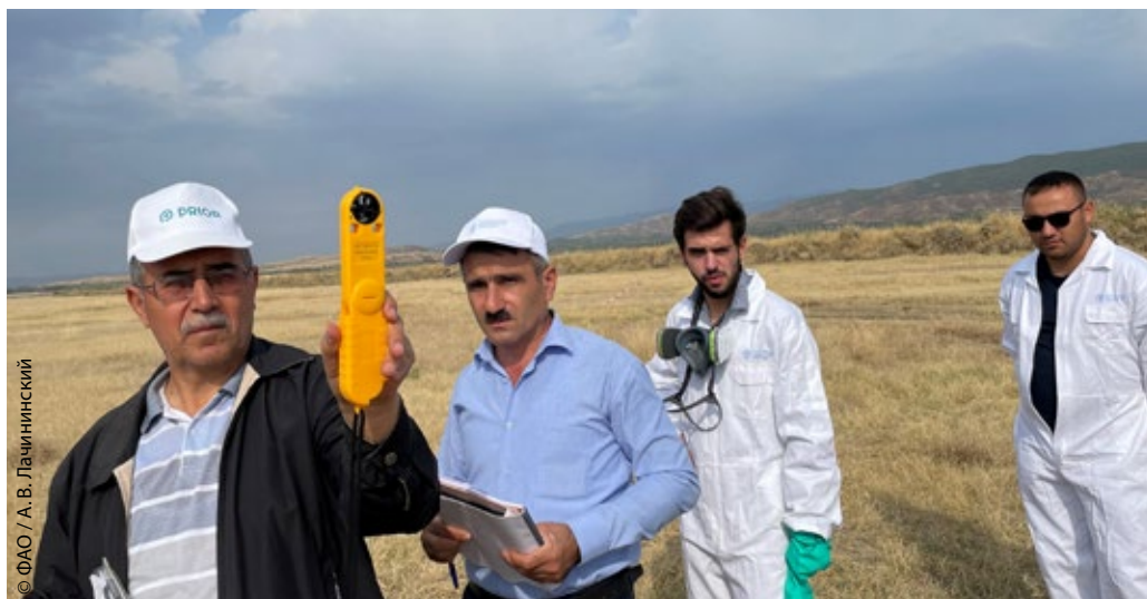
Рис. 13.19. Специалист Агентства аграрных услуг МСХ Азербайджана И. Байрамов проводит определение метеорологических параметров перед обработкой против саранчовых с помощью термоанемометра во время регионального тренинга тренеров ФАО. Кахетия, Грузия, сентябрь 2022 г.
