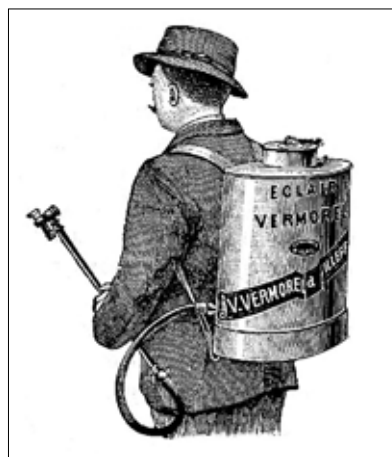
Рис. 13.1. Ручной ранцевый опрыскиватель Виктора Вермореля (Франция).
