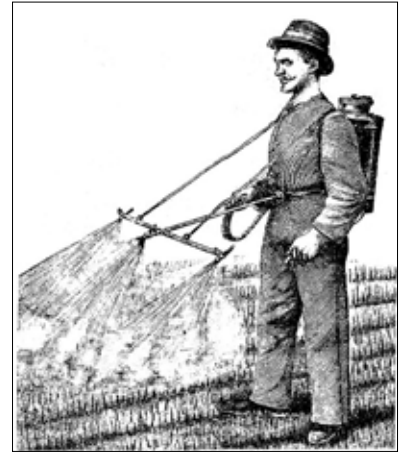
Рис. 13.2. Ручной штанговый опрыскиватель Карла Платца. См.: Стельмахович, Е.Л. 1906. Инсектисиды, фунгисиды, гусеничный клей и опрыскиватели (для борьбы с вредными в сельском хозяйстве насекомыми) . Санкт-Петербург, Департамент земледелия.
