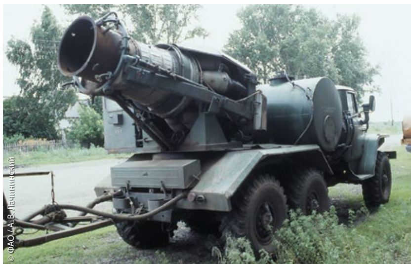
Рис. 13.11. Одна из модификаций аэрозольного генератора. Павлодарская область, Казахстан, 2000 г.
