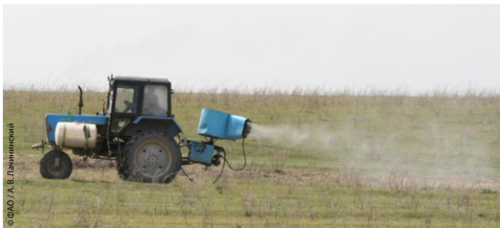
Рис. 13.20. Обработка тракторным вентиляторным опрыскивателем ОВХ-600 против мароккской саранчи Locustotaurus maroccanus (Thunberg) в Джизакской области Узбекистана. Май 2011 г.
