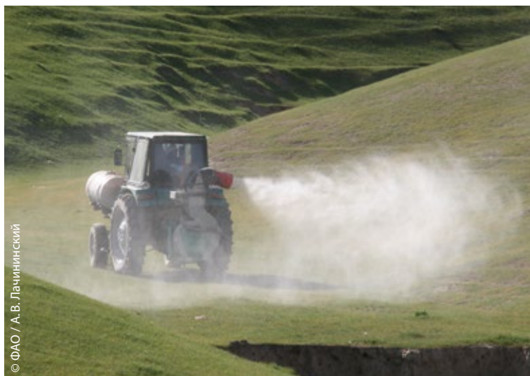
Рис. 13.21. Обработка тракторным малообъёмным опрыскивателем «Тифоне» против мароккской саранчи Locustotaurus maroccanus (Thunberg) в Сурхандарьинской области Узбекистана. Март 2022 г.
