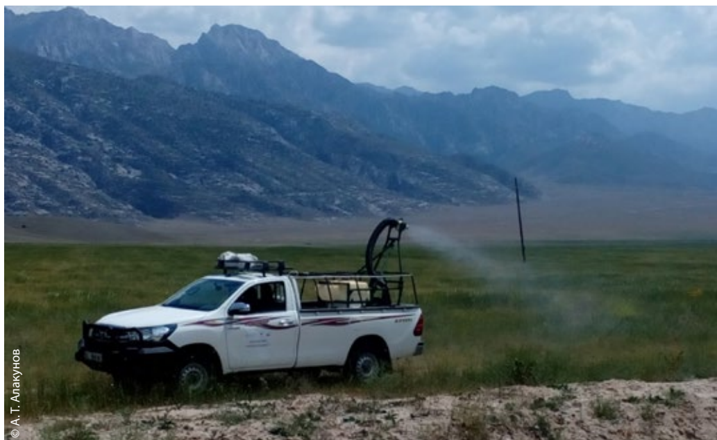
Рис. 13.16. Обработка против мароккской саранчи Docioctaurus maroccanus (Thunberg) с помощью опрыскивателя Micron AU8115, смонтированного на автомобиле. Баткенская область, Кыргызстан, май 2019 г.
