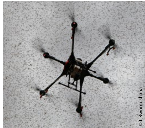
Рис. 12.11. Мультироторный БПЛА (модель DJI Agras T16) во время обследования очагов пустынной саранчи Schistocerca gregaria (Forskål) в графстве Самбуру, Кения. Август 2020 г.
