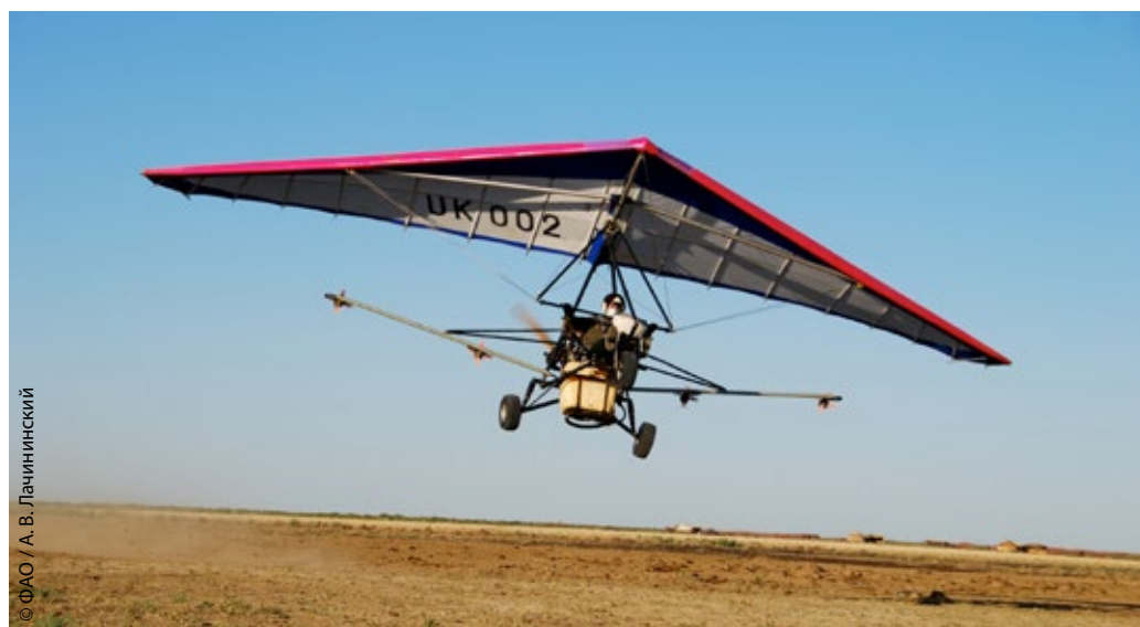
Рис. 13.13. Мотodelтаплан, оснащённый атомайзерами для опрыскивания. Узбекистан, 2008 г.
